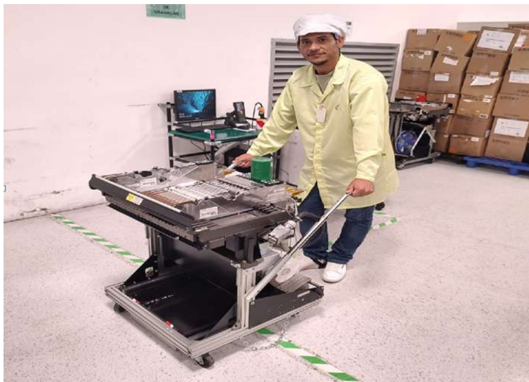
Figura 19 – Equipamento Feeder Cart
